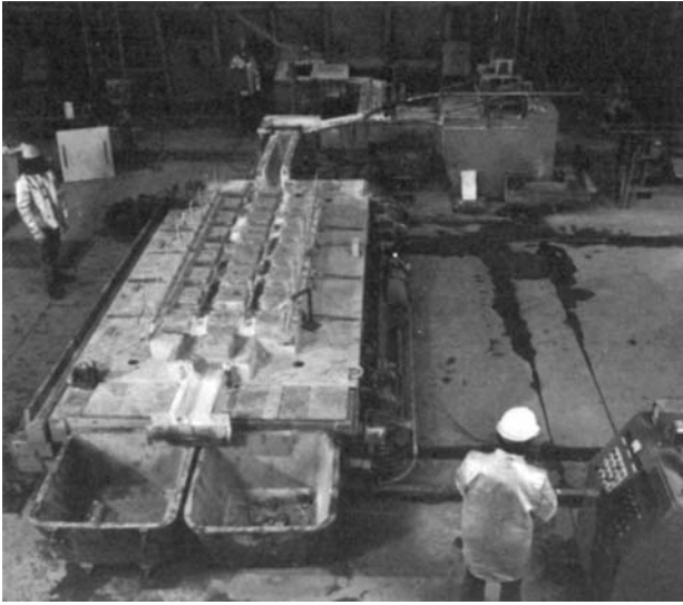
Fig. 11 Hot-top level pour system. Source: Ref 1
